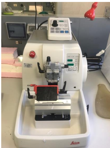
Figura 14. Microtomo rotativo Leica RM2255
